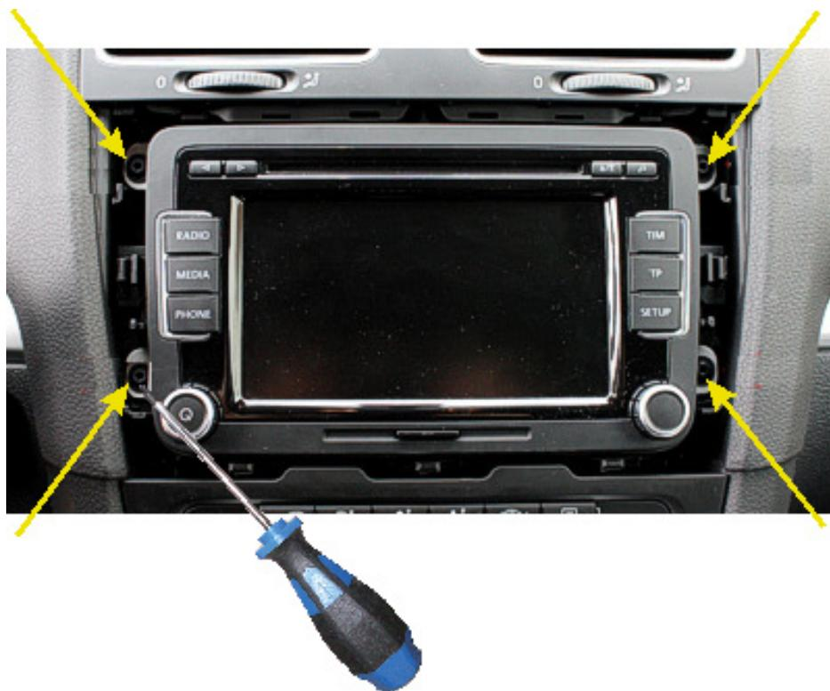
2. Mit einem Schraubendreher die vier gekennzeichneten Torxschrauben (T20) lösen.
