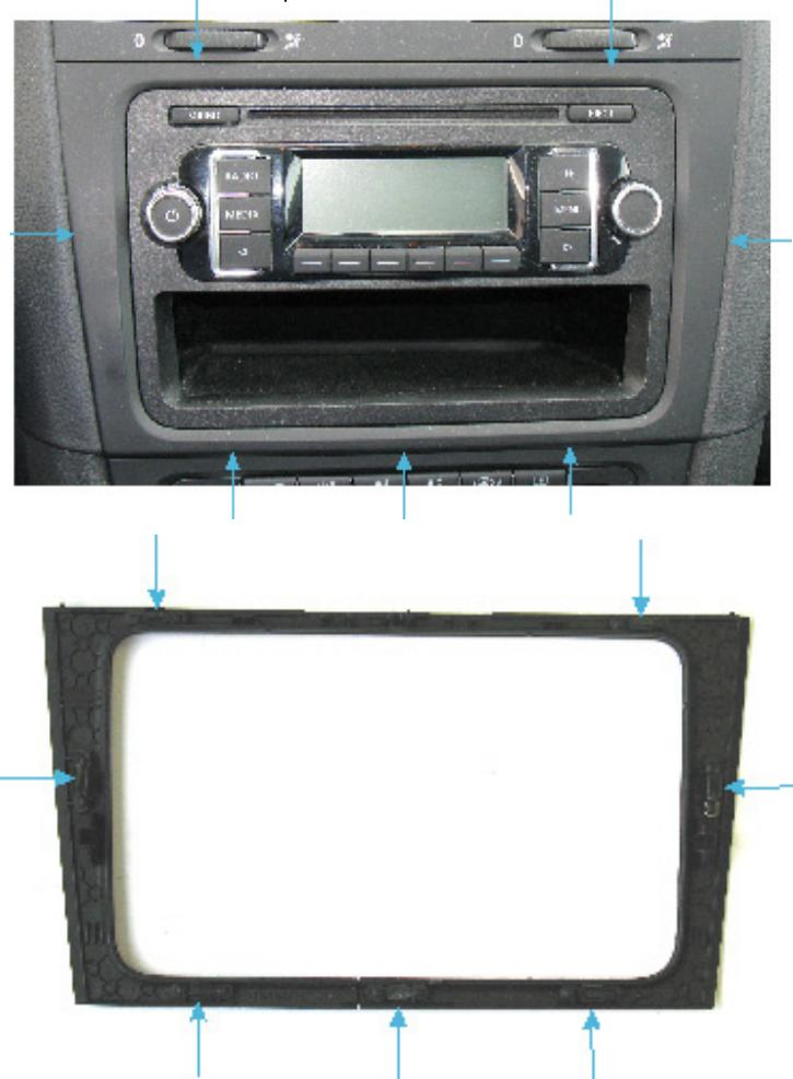
La façade déposée comporte des ergots à l'arrière.
